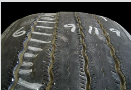
Usure en dépression (intermédiaire)
