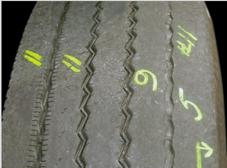
Usure marquée sur un côté
