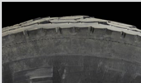
Usure en dents de scie
