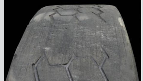
Domage par blocage des freins
