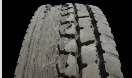
Domage par pièce du véhicule/patinage
