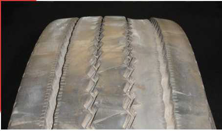
Usure en dépression (nervure intermédiaire)
