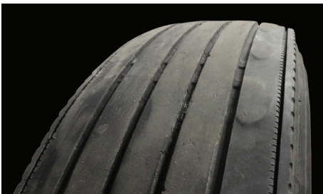
Usure en dépression (épaulement)
