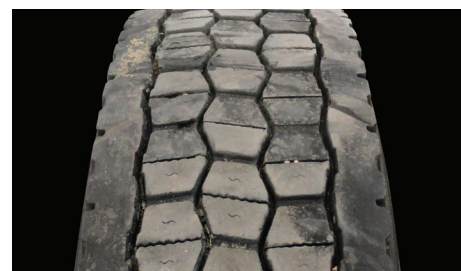
Usure en patates/facettes/ alternance des pains de gomme
