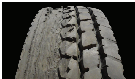
Domage par pièce du véhicule/patinage
