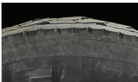
Usure en dents de scie
